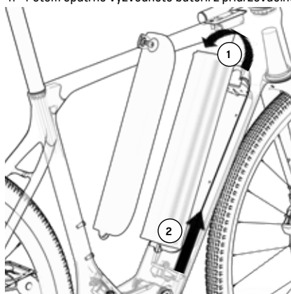
Obr. 3 / Strana zámku nahoře
